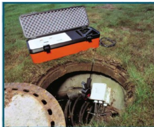
Lakatfógó alkalmazása a szelektív besugárzásnál egy vezetékre a kötegből.
