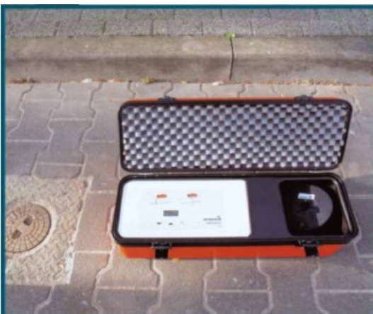
Induktív besugárzás az integrált keretantennával.
